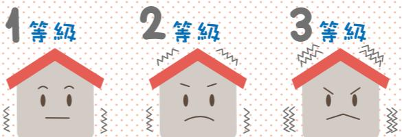
耐震等級とは、建物の強度を表す指標のこと。品確法(住宅の品質確保の促進などに関する法律)に沿った住宅性能表示で、地震による倒壊防止と損傷防止を基準に、3つの段階に分かれています。『耐震等級1』は、数百年に一度程度の地震と言われる震度6強から7程度の地震でも建物が倒壊しない、数十年に一度とされる震度5程度の地震でも建物が損傷しないことが基準になります。『耐震等級2』では、等級1で想定される1.25倍の地震が起きた場合でも建物が倒壊しないことが基準になります。『耐震等級3』は、等級1で想定される1.5倍の地震が起きた場合でも建物が倒壊しないことが基準になります。
